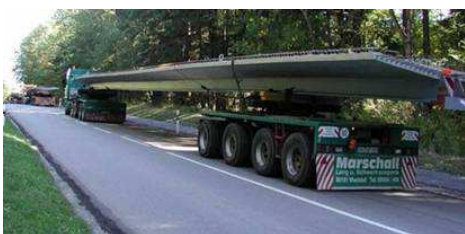
Rys. 2. Obiekt z dźwigarów VFT-WIB (wiadukt w Pöcking): a) dźwigary walcowane po przecięciu i zabezpieczeniu antykrozyjnym w warsztacie, b) zespolenie płyty prefabrykowanej, c) transport dźwigarów na plac budowy, d) montaż dźwigara o długości 32,5m (belka dwuprzęsłowa)
