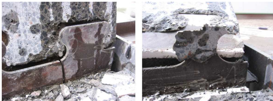
Rys. 4 Próby NPOT: zmęczeniowe pęknięcie próby o kształcie PZ w połączeniu z brakiem kohezji oraz kształt CL bez pęknięcia i z występującą kohezją
