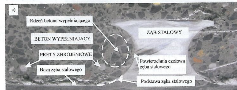
Rys. 3. Stalowe łączniki jako części składowe zespolenia: a) łączniki sworzniowe (rozwiązanie klasyczne), b) zespolenie composite dowels kształt PZ, c) zespolenie composite dowels kształt MCL (fot. INTOP Szczecin)
