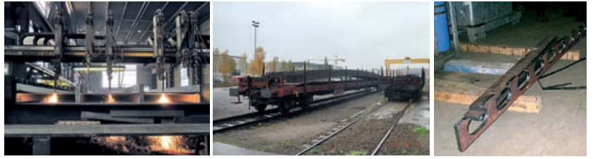
Fot. Na fotografiach przedstawiono belki, z których wykonane zostanie przejście ekologiczne PE4
